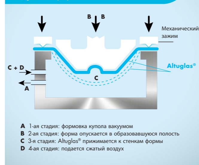
Рис. 3: Формовка прессованием и выдувным формованием
